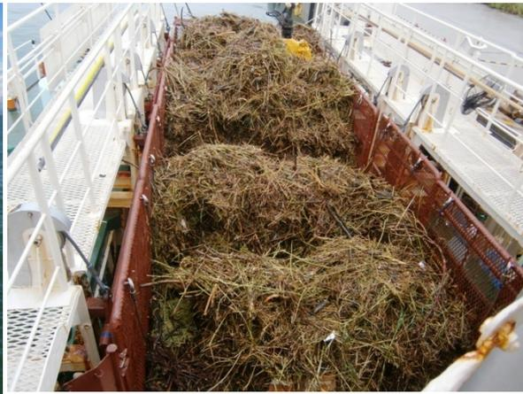
ゴミ回収装置に回収されたゴミ
