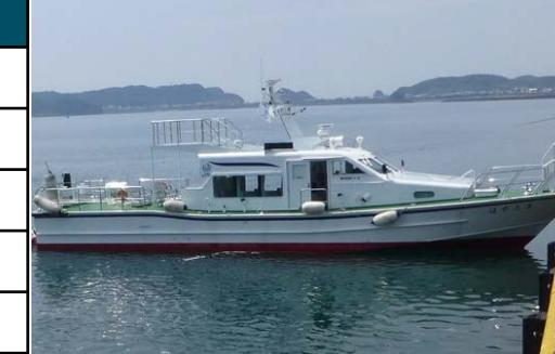
【留意事項】「はやたま」係留時の泊地水深について、ウォータージェット推進の底泥巻き上げによる土砂等を推進機に吸い込み、機関故障の原因となるため、-3.5m以深の水深が望ましい
