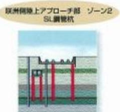
地盤が沈下してもSL鋼管杭を採用することによって道路が沈下しない。
