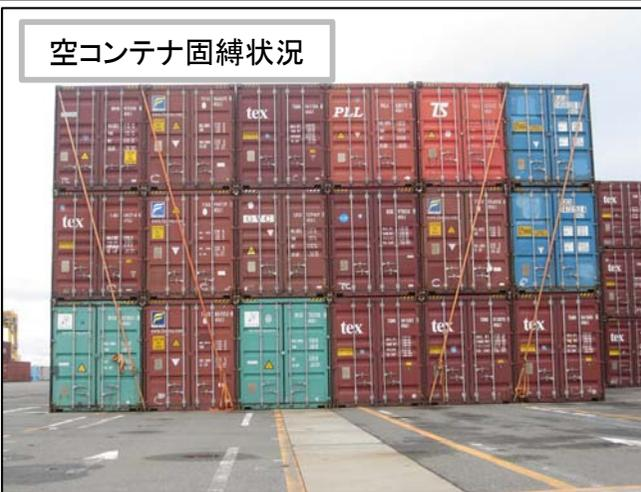
固縛器具によるコンテナ同士の接続
