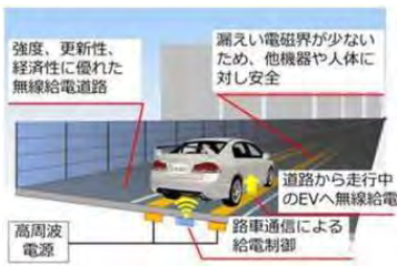
▲走行中給電施設
