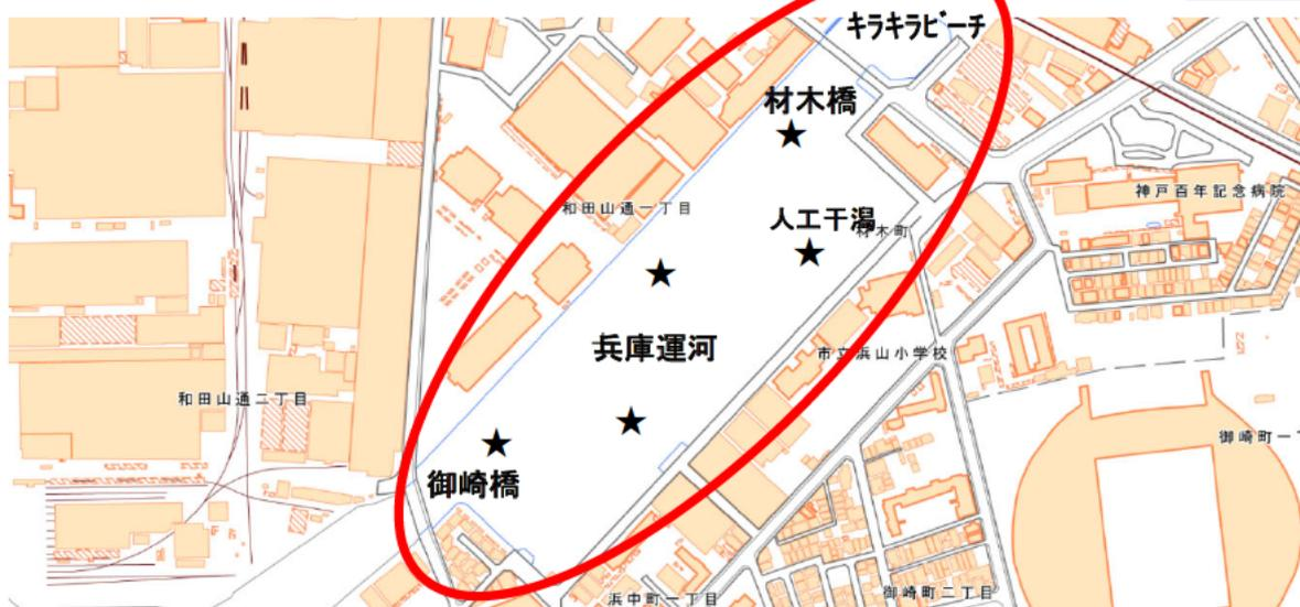
※御崎橋、材木橋から1時間毎に水質測定、採水・分析、流速測定(24時間体制)
