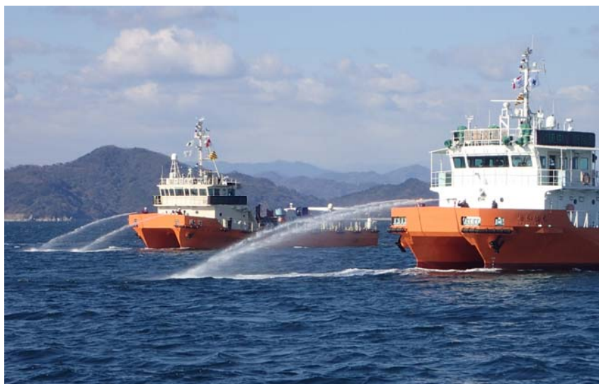
③海洋環境整備船による流出油対策（放水拡散）
