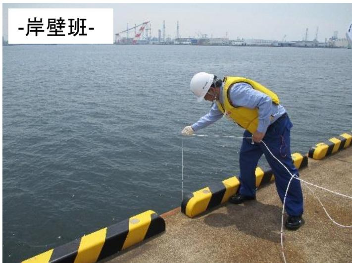
レッド測量による岸壁水深の計測
