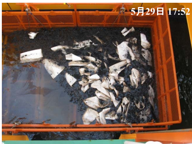
コンテナ式ゴミ回収装置による スラッジ(吸着マット含む)の回収
