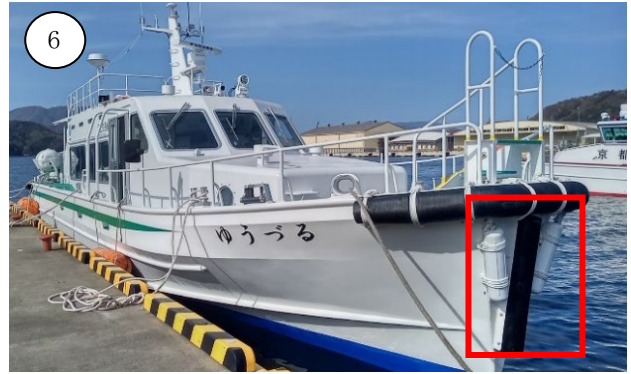
写真8 船首防舷材の延長及び両側白色防舷材取付
