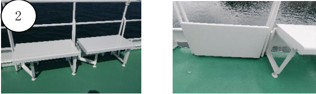
写真4 客室頂部 折り畳み椅子 (左:折り畳み前, 右:折り畳み後)
