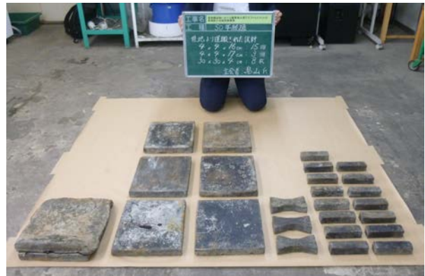
写真-3 取り出した供試体
