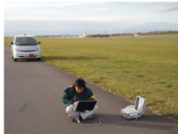
図-4 常時微動観測の様子
