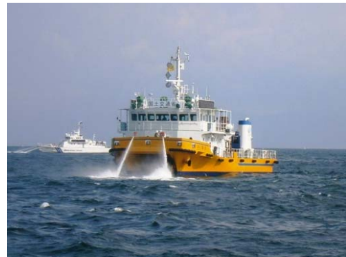
図-14 浮遊油を放水拡散する海洋環境整備船
