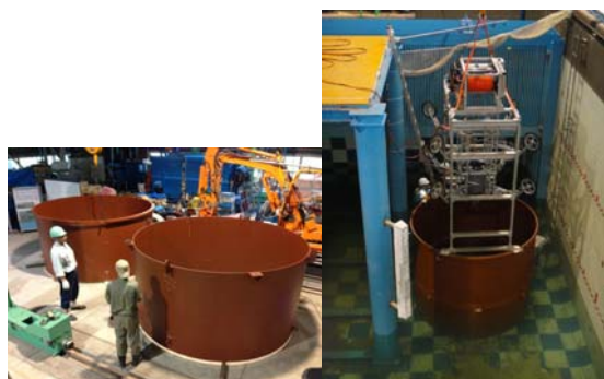
図-8 下部鋼管模型（左），模型への装置設置状況（右）
