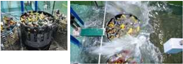
図-8 中詰め抜け出し実験
