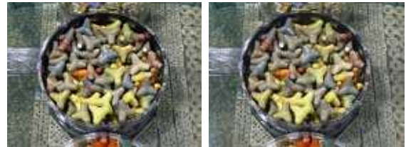
図-15 消波ブロックの造波前(左)と造波後(右)の状況 (不規則波: H_{1/3}=7.4m , T_{1/3}=12.3s )
