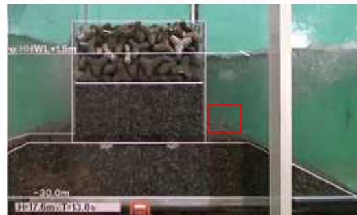
図-16 消波ブロック落下状況 (規則波: H_{max}=17.6m , T_{1/3}=13.8s )
