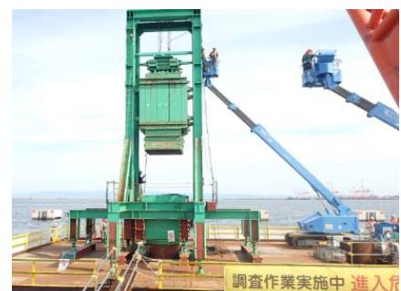
急速載荷試験の実施状況
