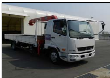
小型移動式クレーン付トラック
