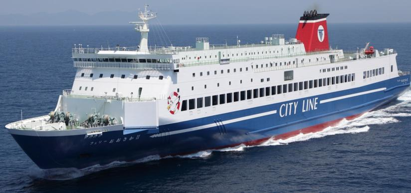
●総トン数／14,920T ●全長／183M 全幅／27M ●航海速力／23.2ノット
