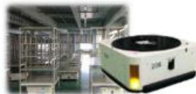
(例) 物流施設においてAIにより制御された無人搬送車が保管棚を運搬
