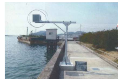
左図: 電波式潮位計イメージ
