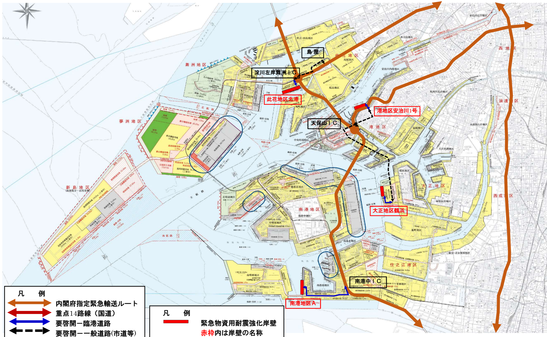
図5 大阪港の緊急物資輸送道路の連続性を確保するための道路啓開計画（案）
