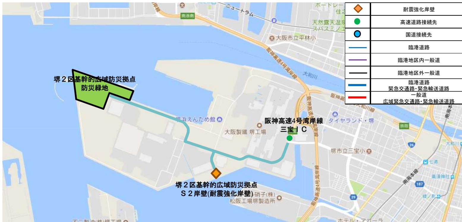
堺2区基幹的広域防災拠点から広域的緊急輸送路迄の道路啓開
