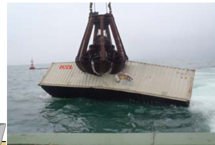
グラブによる揚収作業 (揚収物には傷が付く可能性がある)
