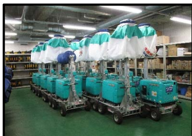
支援施設棟物品保管庫 (発動発電機付投光器)
